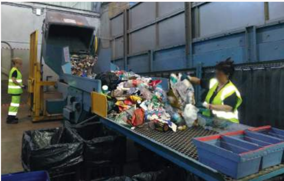
Caractérisation au centre de tri du Muy (Analyse d'un échantillon de déchets prélevés sur une collecte de bacs jaunes)
