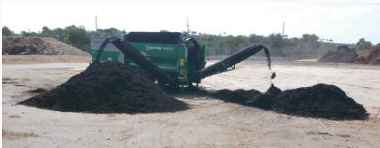
Criblage du compost
